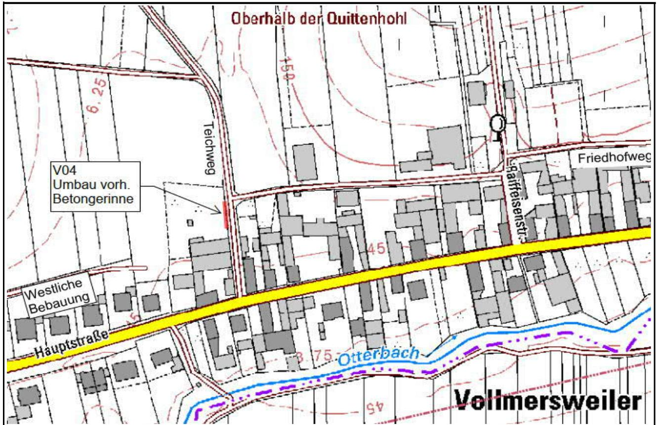
Erläuterungen: Querriegel sind einzubauen, um der Abflussbeschleunigung entgegenzuwirken. Verkehrssicherung des vorhandenen Betongerinnes.
