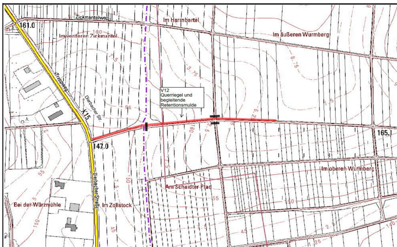
**Erläuterungen:** Lenkung und Rückhalt von Oberflächenwasser durch Querschläge über Wirtschaftswege und Retentions- / Versickerungsmulden. Die Mulden sind, aufgrund des starken Längsgefälles, kaskadenförmig anzulegen.
