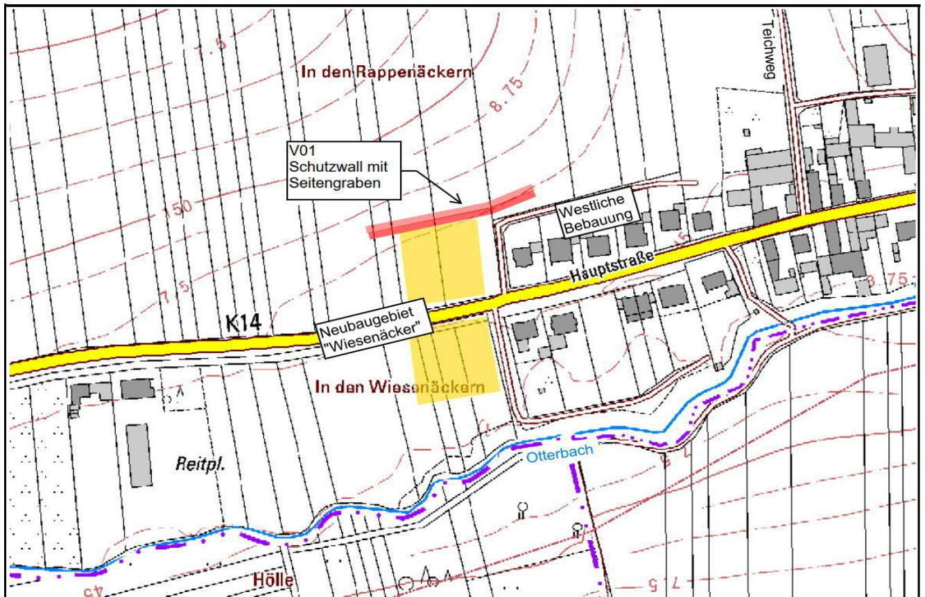
**Erläuterungen:** Lenkung/Rückhalt von Oberflächenwasser durch Schutzwall mit Retentions- / Versickerungsmulde zum Schutz des geplanten Baugebiets "Wiesenäcker" und der westlichen Bebauung. Bodengutachten liegt nicht vor. Länge des Schutzwalls: 100 m
