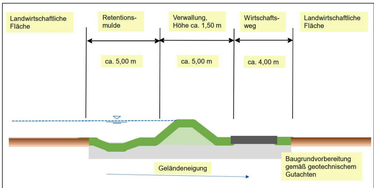
Abb. 6-2: Ortsgemeinde Vollmersweiler, Schema der Dammanlage im Querprofil
