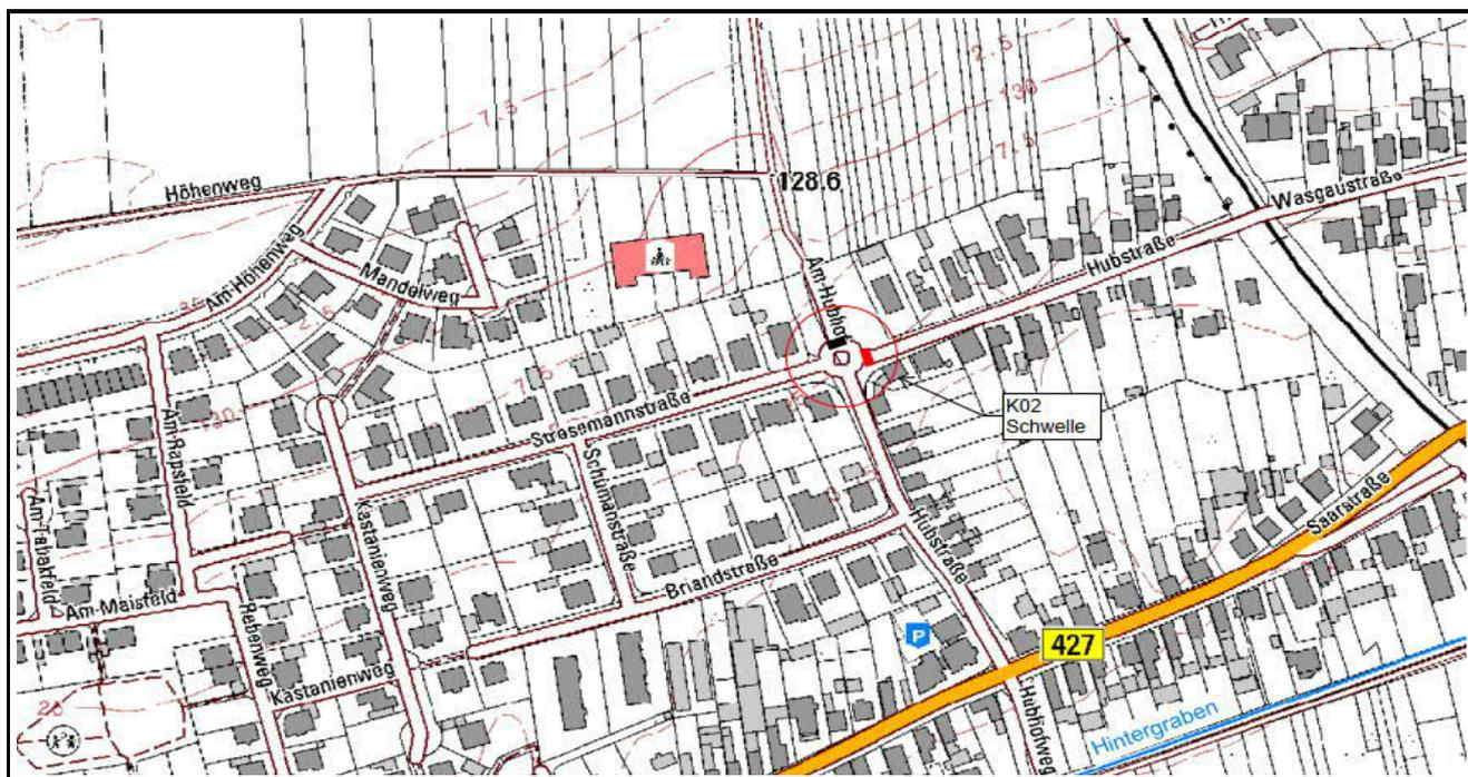
**Erläuterungen:** Querrinne auf nördlicher Seite des Kreisels bereits vorhanden. Schwelle auf östlicher Seite des Kreisels zur Lenkung des Oberflächenwassers nach Süden.
