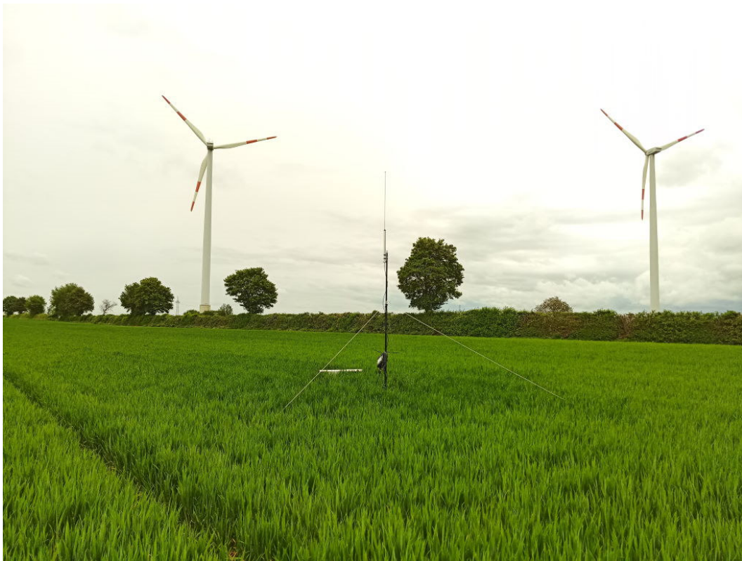
Abb. 4: Automatische Telemetrie-Erfassungseinheit „Mi02“ mit Antenne, Receiver in Otterbox und Energiequelle (Autobatterie in Alu-Box mit Solarpanel) nahe des geplanten Standort der WEA 2.
