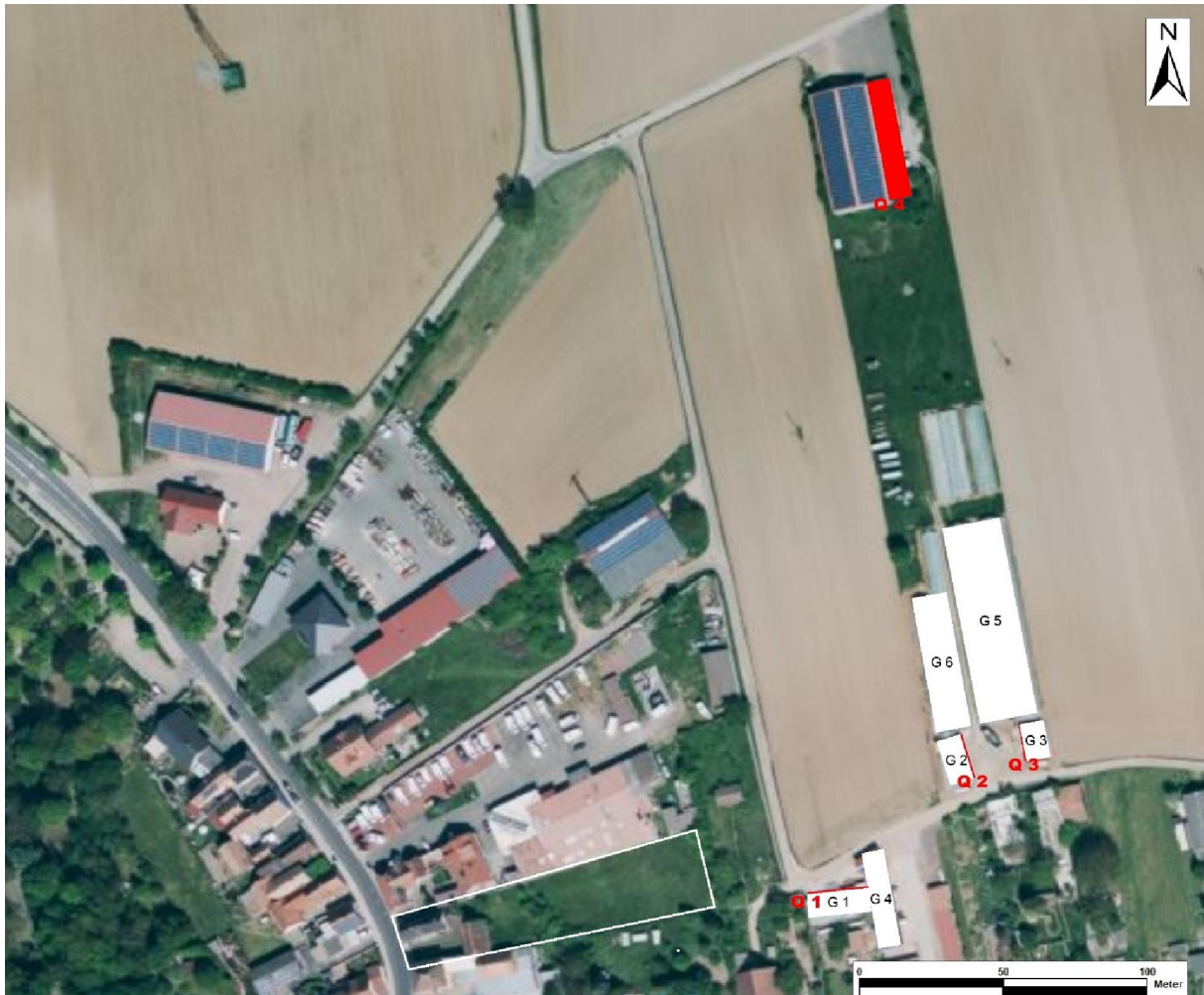
Abb. 5.1: Quellenplan: Q1 - Q4: Emissionsquellen der Tabaktrocknung; G1 - G6: relevante Gebäude
