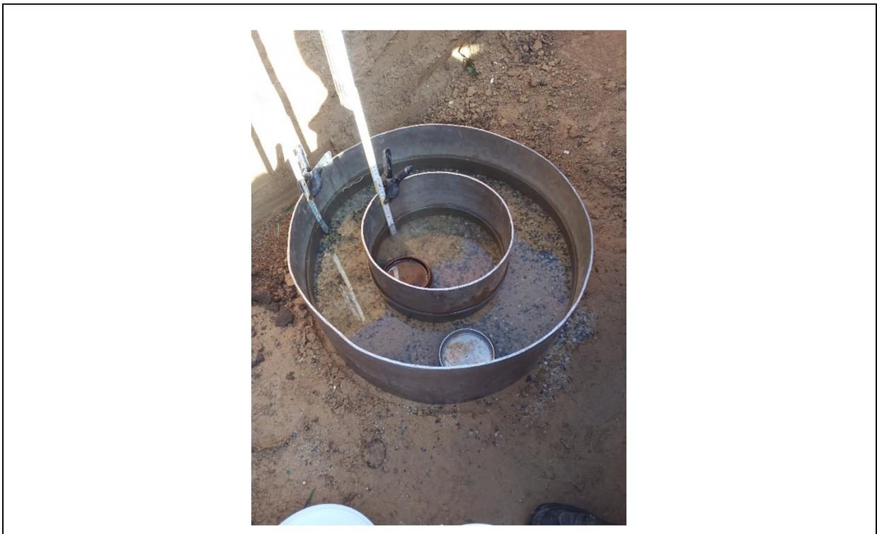
Bild 2: Eingebauter DI-Versuchsstand in SCH1 (20.02.2023)
