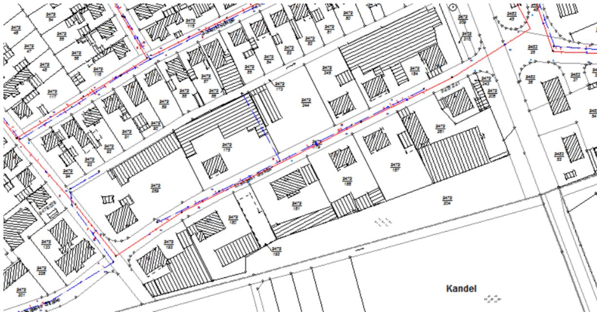
**Abb. 3: Aktueller Verlauf der Schmutz- und Regenwasserkanäle**
