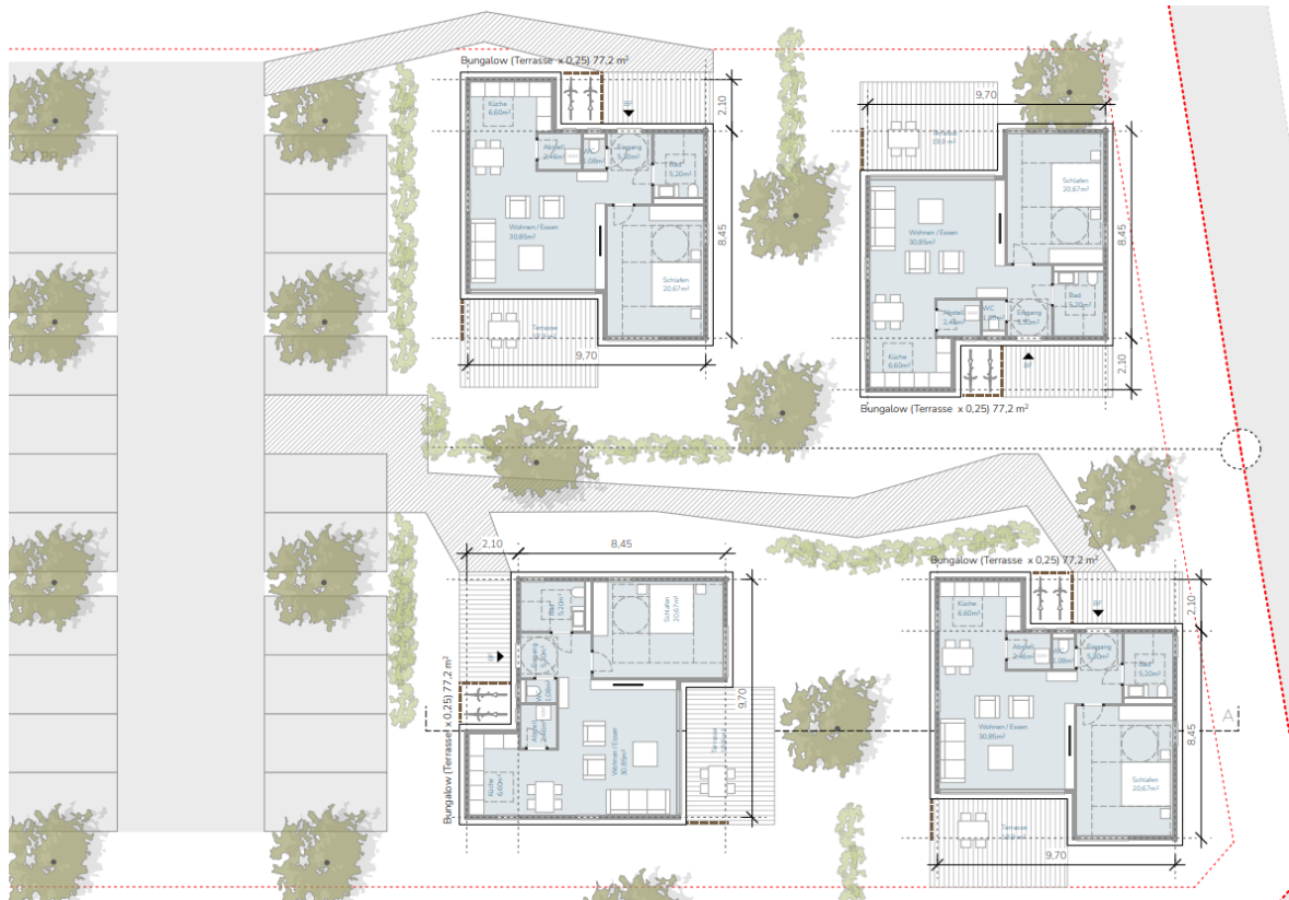
Abbildung 4: Bungalows Grundriss EG, ohne Maßstab, Quelle: AP+M Architekten GmbH, Stand vom 26.08.2025
