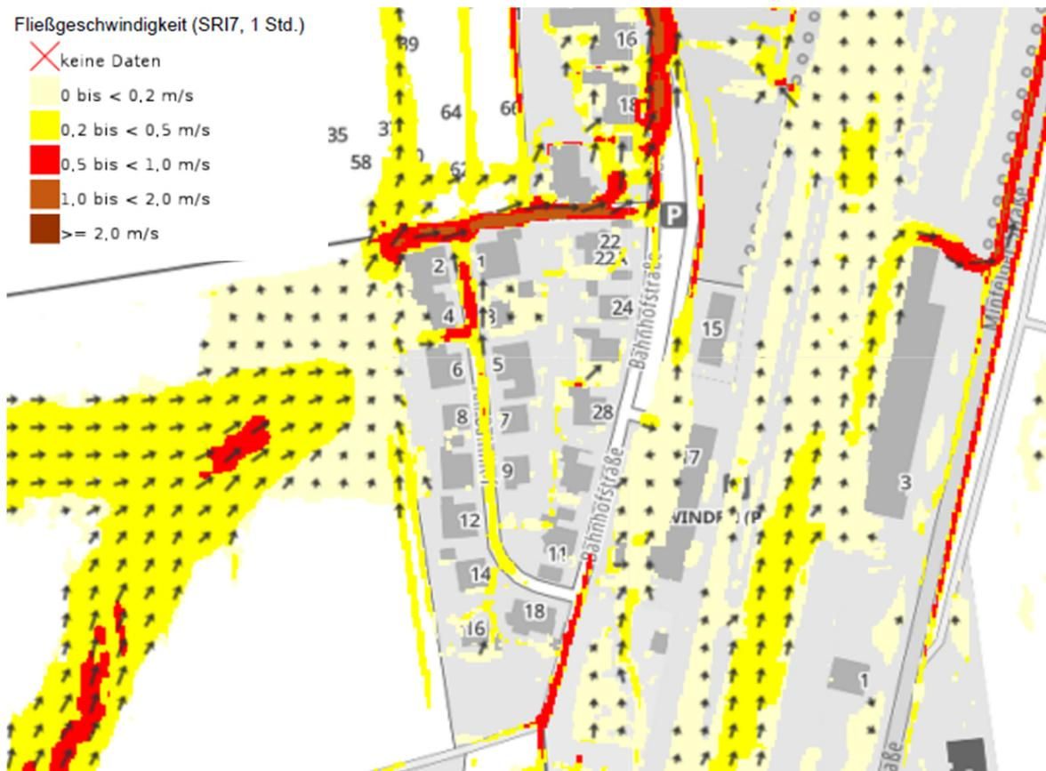
Bild 3: Fließgeschwindigkeiten bei außergewöhnlichem Starkregen (SRI 07 – 1std.), Geoportal Wasser RLP
